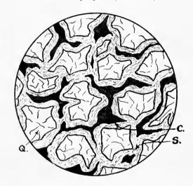
Q .- Quartzite. C .- Chalcocite. S .- Silicious Cement.
