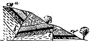
Fig. 117. Couche disloquée par des failles.
