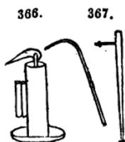
projette un dard de flamme extrêmement actif, fig. 366, devant lequel un grand nombre de corps peuvent se fondre. Le chalumeau, formé d'un tube conique de fer-blanc et d'un petit tube transverse placé à une certaine distance du fond, fig. 367, est très-convenable, parce que s'il s'introduit un peu de salive, elle n'est pas projetée sur la pièce d'essai : en renversant le tube, elle s'égoutte facilement.
