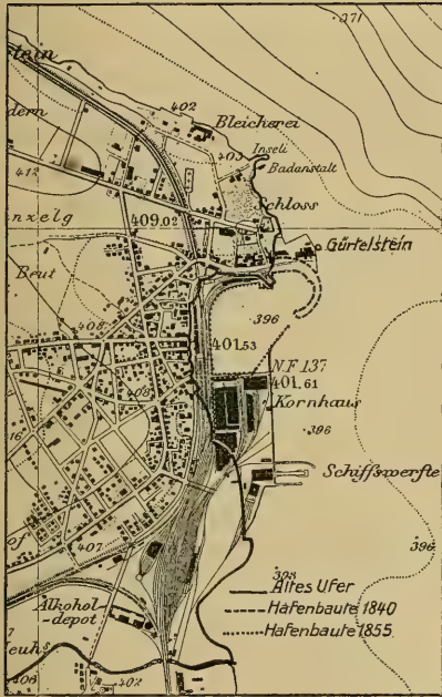
Fig. 9. Die Hafenbauten von Romanshorn. (Nach den Plänen des thurg. Baudepartements in die Siegfriedkarte eingetragen.)
