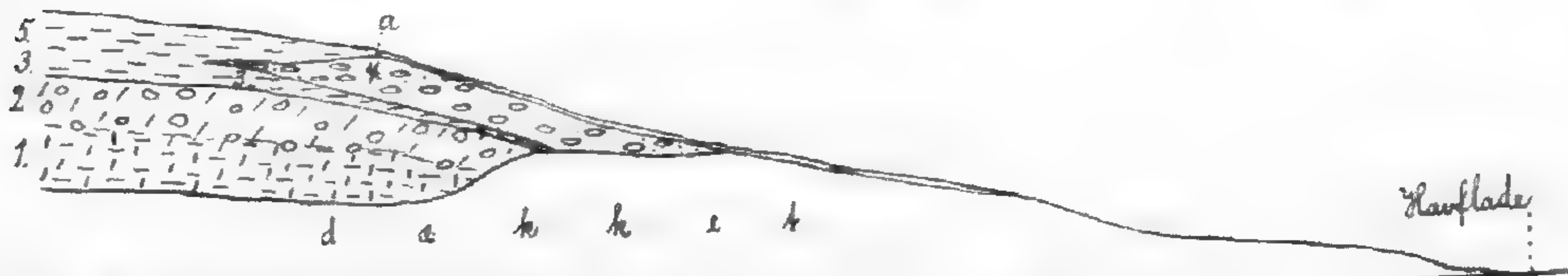
Fig. 5. Profil ved Bæjará. 1. Ler. 2. Lerblandet rullet Grus. 3. Tørveagtig gammel Jordsmon. 4. Sandblandet rullet Grus med Periostracum af Mytilus modiolus . 5. Tørv dækket med Grønsvær. a. Strandvoldens Ryg (3,8 M. o. H. c. 20 M. fra Stranden).
