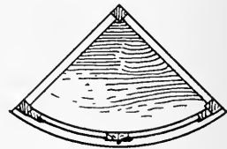
SECTIONAL · PLAN · · · THRO · CUPBOARD · OF · CORNER · WASHSTAND ·
