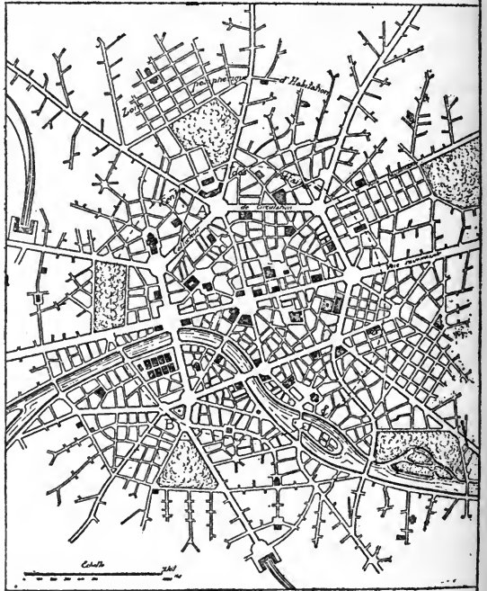
Fig 5 Schéma théorique d'un Système de Circulation avec voies rayonnantes et collecteurs centraux
