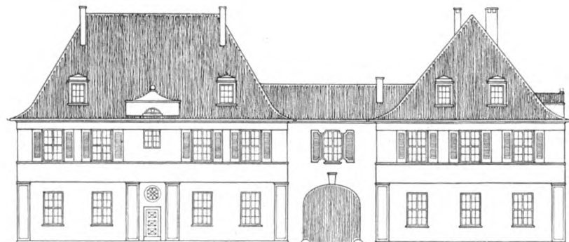
Aufriß der Rückfassade. — Maßstab 1 : 300
