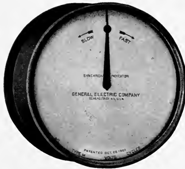
Fig. 131.—Synchronism indicator. G. E. Co.
