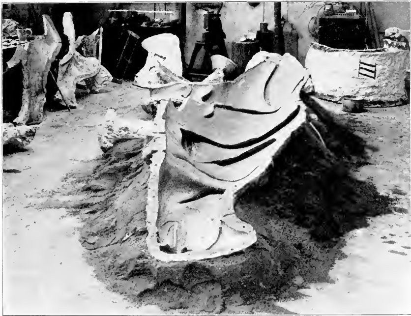
Fig. 6. Zusammensetzen der einzelnen Formstücke.
