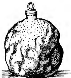
Abb. 28. Versuch der Akademiker über die Zusammendrückbarkeit des Wassers 4) .
