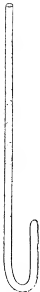
Abb. 65. Boyles Versuch, eine Beziehung zwischen dem Druck und dem Volumen eines Gases zu finden 4) .
