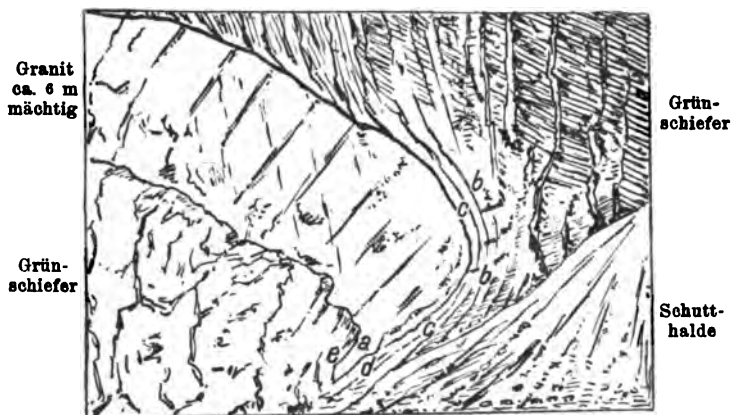
Fig. 3. Ende des Granitganges in Grünschiefern bei 2807 m am Oberaletschgletscher. a Concordante Einquetschung des Granits in die Schiefer. b Anschmiegung des Schiefers an den Granit. c-e vide Text.
