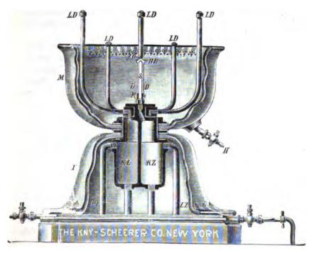
Temperatur erwärmt resp. abgekühlt dadurch, dass die Leitung einem Wärme- resp. Kühlrohr, an welchem man die Temperatur ablesen kann, passiert. Der Apparat wird mitten auf den Boden des Inhalationsraumes gestellt und wird der Raum, dessen Inhalt 15 Kubikmeter sein sollte, von nur einem Patienten zur Zeit benutzt werden.
