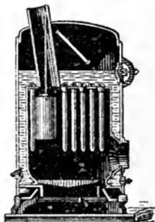
Machine verticale. Coupe de chaudière tubulaire.
