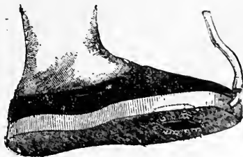
Fig. 253. — Chaussure exploratrice des appuis du pied sur le sol.
