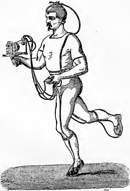
Fig. 255. — Coureur muni de chaussures exploratrices et portant l'appareil inscripteur du rythme de son allure (Marey).
