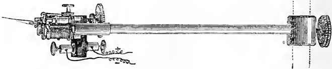
Fig. 500. — Signal électrique de Marcel Deprèz .
