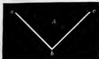
Fig. 422. — Double fente en V, pour obtenir deux spectres partiellement superposés.
