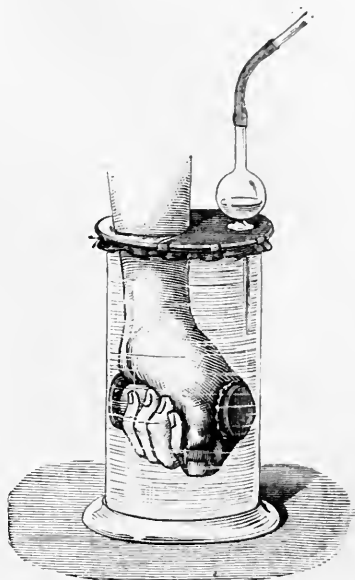
Fig. 360. — Appareil de François-Franck pour les changements de volume de la main,
