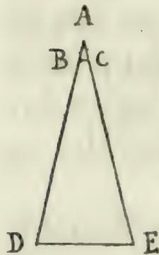
de la proportion de la vitesse dont les cors descendent, que le petit triangle ABC oste du triangle ADE, si on pose la ligne BC pour le premier moment de vitesse, & DE pour le dernier. D'où vous pouuez aisément calculer la force de la Percussion comparée avec la Pesanteur, *positis ponendis*. Et à cause qu'en ces suppositions on se peut beaucoup éloigner de la verité, le tout estant question de fait, ie ne m'en méleray point, s'il vous plaist.
