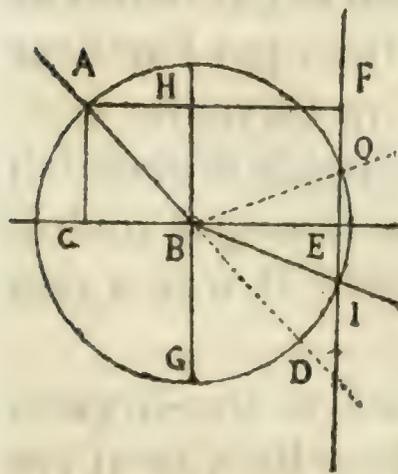
mine la bale en entrant dans l'eau, à cause que, par apres, quelque resistance que l'eau luy fasse, cela ne peut changer sa determination. Comme, par exemple, si la bale qui est poussée d'A vers B, estant au point B, est déterminée par la superficie CBE à aller vers I, soit qu'il y ait de l'air au dessous de cette superficie, soit qu'il y ait de l'eau, cela ne changera point sa determination, mais seulement sa vitesse, qui diminuëra beaucoup plus dans l'eau que
