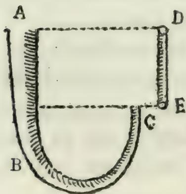
ture C du tuyau ABC n'est pas plus large que E, celle du tuyau DE, & que les deux lignes AD & CE soient paralleles à l'Horison, encore que tout le reste de l'vn de ces tuyaux soit plus large, pouruû qu'aucun endroit de l'autre ne soit plus étroit, & 15
