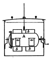
Der Cylinder A ruht mit seiner Axe auf zwei Stützen und communicirt an der einen Seite mit einer Handhabe. Die Handhabe sitzt am Kasten; und der Cylinder A kann nach Ablösung von der Handhabe aus dem Kasten genommen werden.
