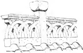
FIG. 106. — Crête de toiture en pierre à Cavaillon (Vaucluse). Revoil, Archit. romane du Midi .
