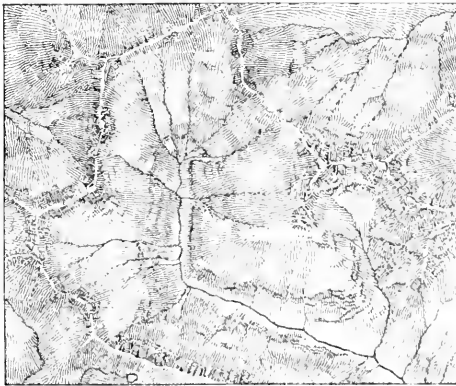
Éclairage par la lumière zénithale.
