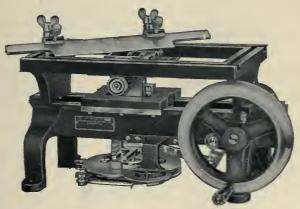
Fig. 4.—Minot precision microtome (Bausch & Lomb).
