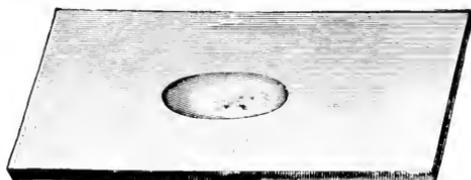
Fig. 4. Ausgehöhlter Objektträger zum Ausziehen von Schnitten und Pulvern, auch als feuchte Kammer zu benutzen. Gräßler & Co., Leipzig.
