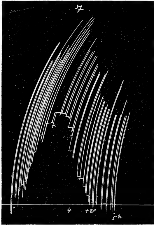
Fig. 21 a. Sartorius von Rana esculenta . Milchsäure 0,005 N. Einwirkungszeit: 5 Minuten von x-x . Elektrisch während der Säureeinwirkung gereizt. (Originalgrösse.)
