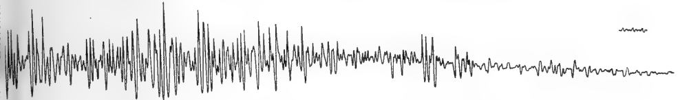
Abb. 1. Knall eines Revolvers. Originallänge der ganzen Kurve 318 mm.
