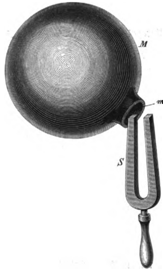
Fig. 2. Helmholtz'scher Resonator und Stimmgabel.
