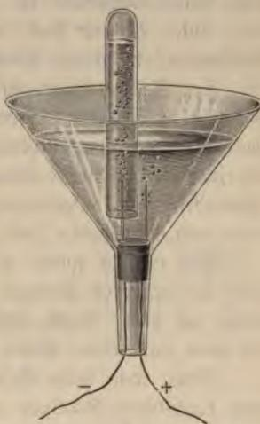
Fig. 137. Zersetzung des Wassers durch den elektrischen Strom.
