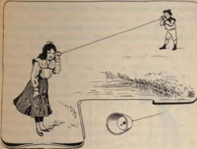
Fig. 36. Ein billiges Telephon (Fadentelephon).
