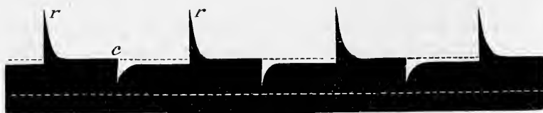
Fig. 19. Tracés de courants induits signalés par l'électromètre capillaire, d'après une photographie grandie deux fois.
