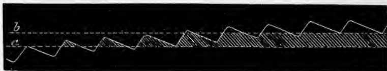
Fig. 30. — Courbe idéale exprimant, par ses inflexions, les phases d'intensité croissante des flux additionnés d'une décharge. L'excursion du style étant limitée entre deux obstacles, il n'y aura d'inscrit que ce qui correspond à l'intervalle des lignes a et b . Cette partie, teinte par des hachures, rappelle l'aspect général de la figure 28.
