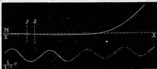
Fig. 23. — Déviation de la plume sous l'influence de la translation du papier, quand le levier n'est pas exactement perpendiculaire à l'axe du cylindre.
