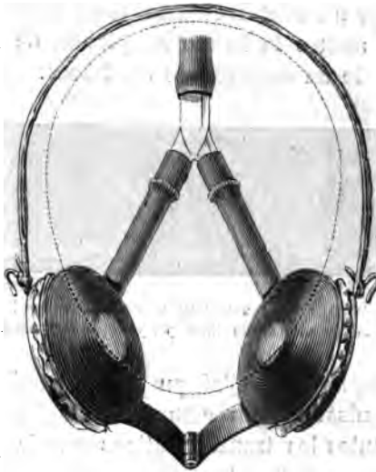
Fig. 108. — Explorateur à deux tambours conjugués pour la pulsation cardiaque des petits animaux.
