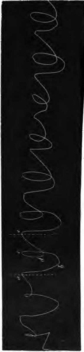
Fig. 82. — Inscriptions combinées des réactions du corps de l'oiseau pendant le vol (expériences faites sur la Buse). A gauche de la figure, réactions des premiers instants du vol ; à droite, réaction dans le plein vol. (Pour l'interprétation de cette courbe, voir l'analyse détaillée qui en a été faite dans la Machine animale .)
