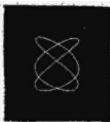
Fig. 80. — Trajectoire d'une verge de Wheatstone, vibrant dans le rapport de 2 à 3 ; tracé recueilli sur un papier immobile.
