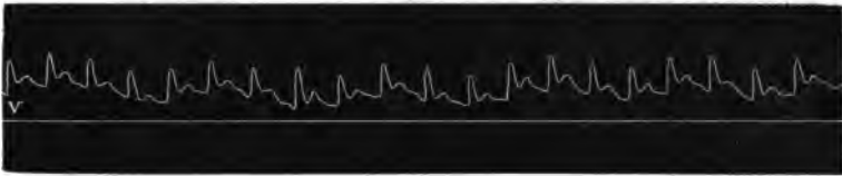
Fig. 2. — Tracé des changements du volume de la main avec un appareil dans lequel sont supprimées les oscillations propres de la colonne liquide.
