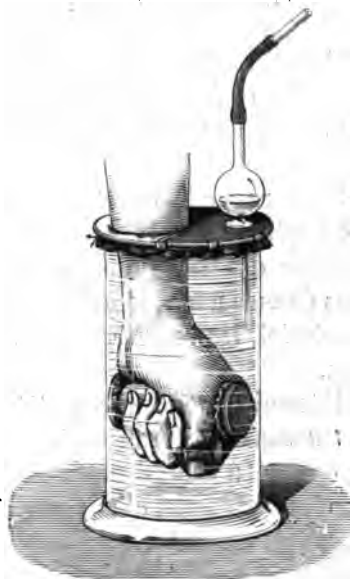
Fig. 3. — Appareil explorateur des changements du volume de la main. — La membrane au travers de laquelle passe l'avant-bras est immobilisée par une plaque métallique ; dans le tube vertical muni d'une ampoule, s'opèrent les changements de niveau qui s'inscrivent à distance à l'aide de la transmission par l'air.
