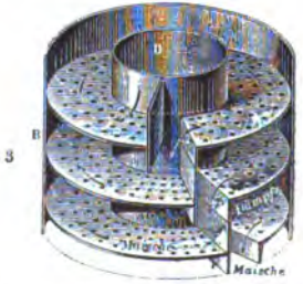
1. Äußere Ansicht des Brenn- und Rektifikationsapparats von Gebrüder Siemens & Co. — 2. Derselbe, Schnitt durch den untersten Teil (den Vorwärmer). — 3. Derselbe, Schnitt durch den mittleren Teil (die Raichkolonne). — 4. Derselbe, Schnitt durch den obersten Teil (den Rektifikator). — 5. Apparat von Collier-Blumenthal, verbessert von Deroëne.
