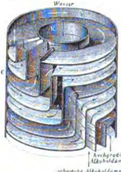
1. Äußere Ansicht des Brenn- und Rektifikationsapparats von Gebrüder Siemens & Co. — 2. Derselbe, Schnitt durch den untersten Teil (den Vorwärmer). — 3. Derselbe, Schnitt durch den mittleren Teil (die Raichkolonne). — 4. Derselbe, Schnitt durch den obersten Teil (den Rektifikator). — 5. Apparat von Collier-Blumenthal, verbessert von Deroëne.
