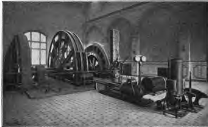
Elektrisch betriebene Hauptschacht-Fördermaschine , System Ilgner , für Zeche Mathias Stinnes in Brauck (Westf.) Nutzlast 4800 kg. Teufe 800 m. Maximale Fahrgeschwindigkeit bei Lastfahrt 14 m/sec., bei Seilfahrt 10 m/sec.
