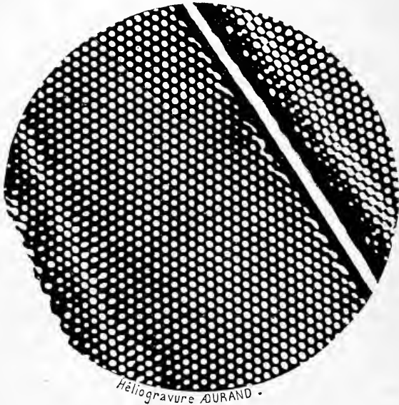
FIG. 8. — Reproduction héliographique d'une photographie de la surface du Pleurosigma angulatum , obtenue avec un fort objectif à immersion et l'éclairage central.
