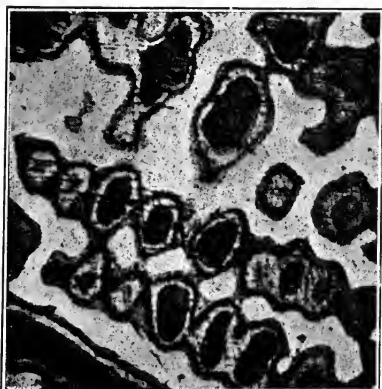
FIG. 5.—Gold, 25 per cent.; Copper, 75 per cent. \times 90 .
