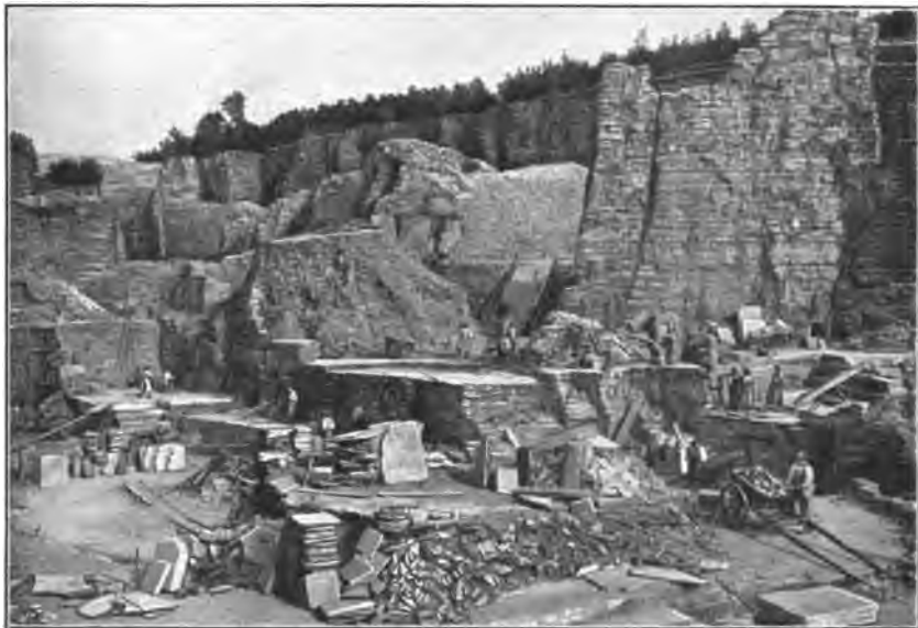
Der Hardtbruch in Solnhofen. Der Jurakalk, ein Abfall aus mesozoischen Meeren, spaltet in Platten und dünnen Blättchen, zwischen denen sich Abdrücke und Darstellungen vorweltlicher Tiere sehr schön erhalten haben. In Solnhofen werden besonders die nur an wenigen Orten vorkommenden, zum Lithographieren geeigneten Steine gefunden, die von hier aus nach allen Teilen der Erde verhandelt werden.
