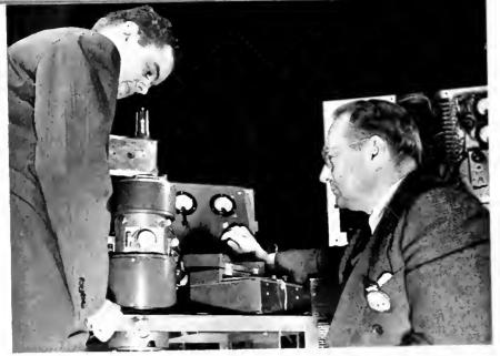
DR. JAMES HILLIER (LEFT) AND DR. V. K. ZWORYKIN OPERATING THE ELECTRON MICRO-ANALYZER DESIGNED TO GIVE AN ELEMENTAL CHEMICAL ANALYSIS OF ULTRA-MICROSCOPIC PARTICLES OF MATTER.
