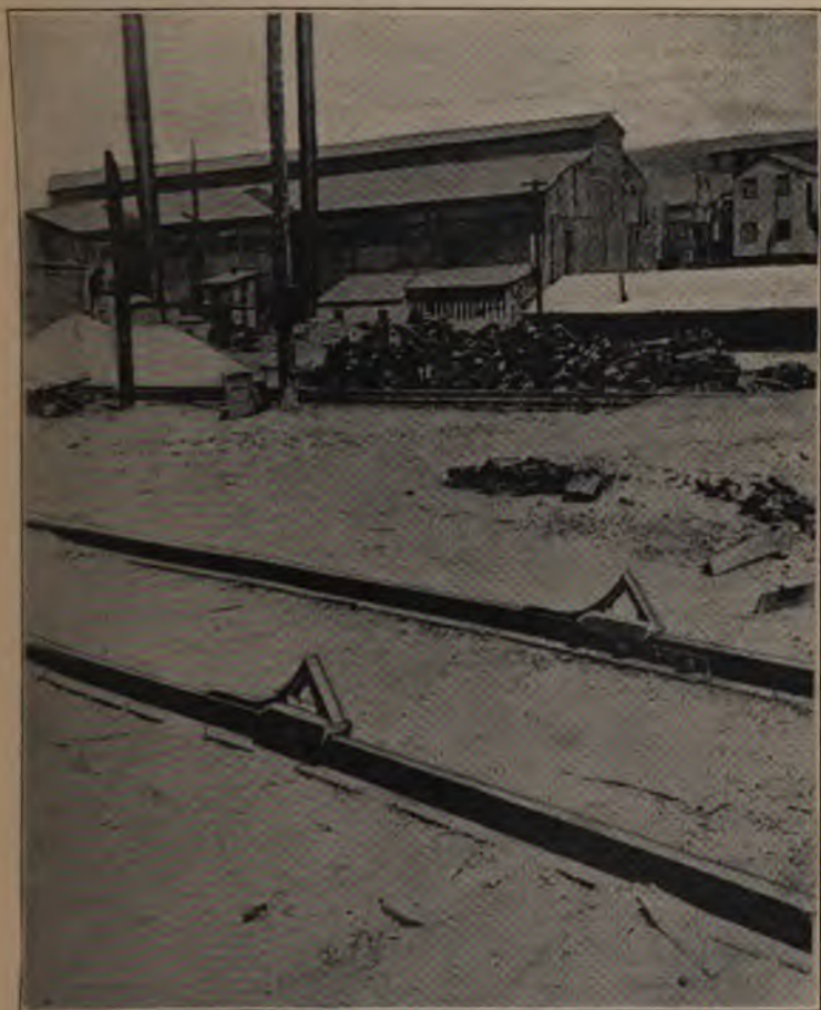
FIG. 8.—“SABOT FRIEN” BRAKE SKID.
