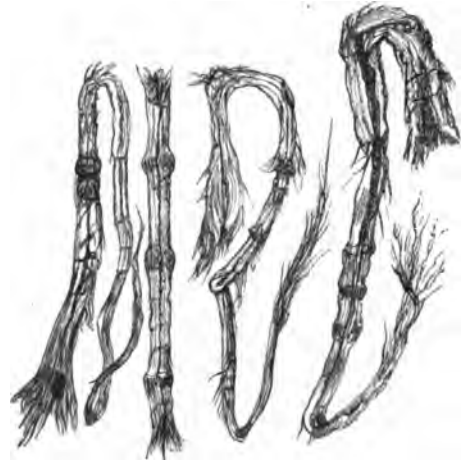
Aus Leinenhadernpapier. Zerstörte, an den Enden in Fibrillen aufgelöste Flachsbastfasern aus einem Briefpapier.
