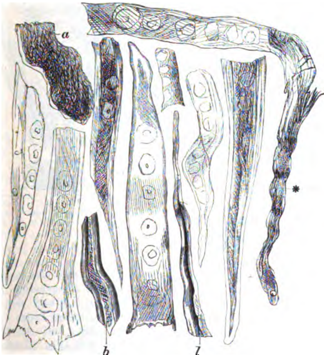
Holzzellulose aus Fichtenholz; a breitgequetschtes Endstück, b baumwollhaarähnliches Bruchstück, gitterförmige Streifung, bei einigen Fasern sehr deutlich.
