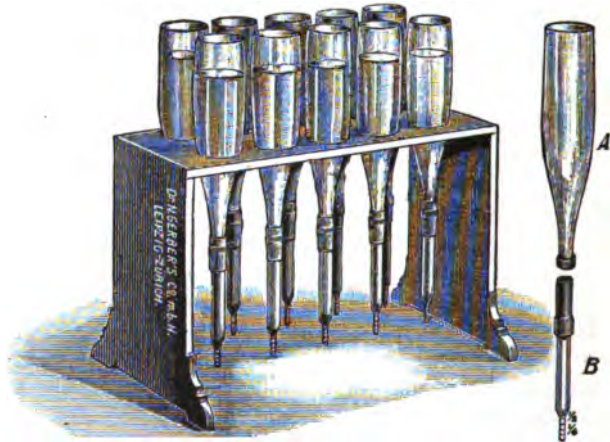
Apparat zur Bestimmung des Milchschnitzes.
