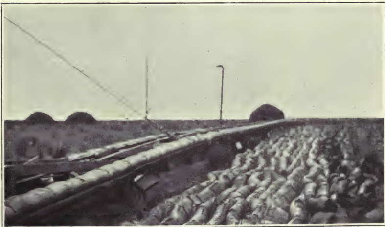
FIG. 59.—Wielandt sod transporter.
