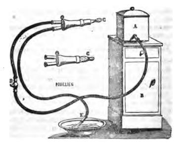
Un réservoir contenant le liquide et adapté au tube, et un robinet pour en régler le cours complètent l'appareil.
