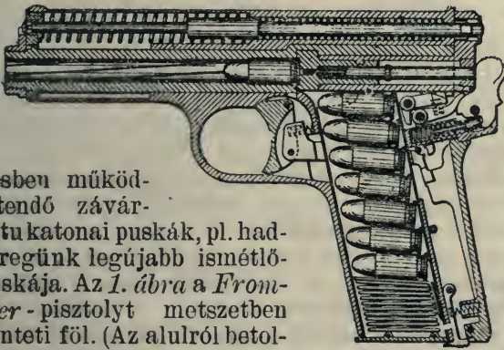
5. ábra. Frommer-Stop pisztoly met-szetben
