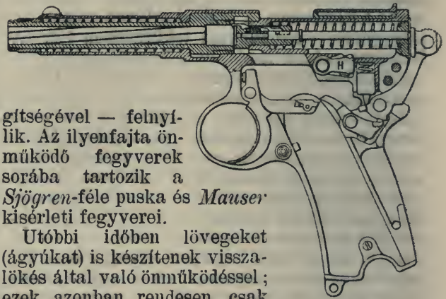
1. ábra. Frommer-pisztoly metszetben.
