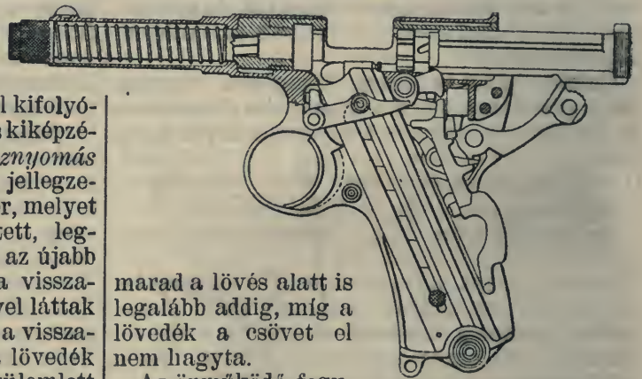
2. ábra. Frommer-pisztoly metszetben.
