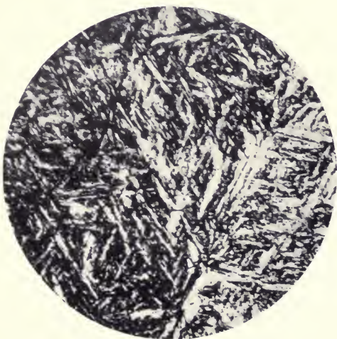
FIG. 2. AUSTENITE (LIGHT) AND MARTENSITE (DARK).
