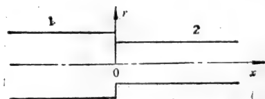
图 7-23 阻抗突变引起的波反射
