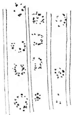
Fig. 1. Verteilung des Kuperoxydulniederschlags im Bereiche der Hoftüpfel an einem Radialschnitte durch Fichtenholz.
