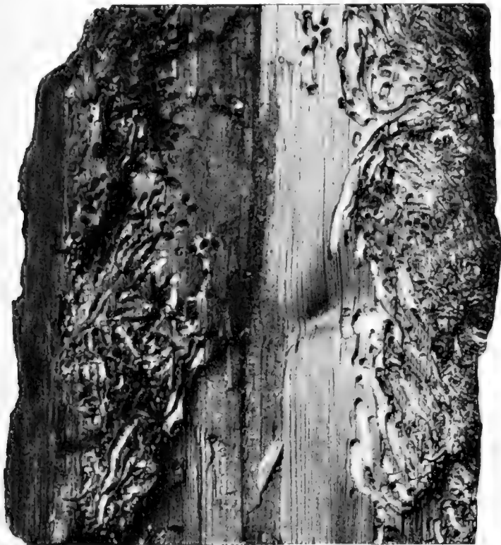
Angrepp af Teredo navalis . (Fot. H. Hesselman).
