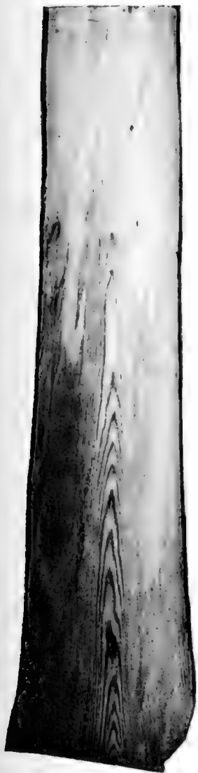
Fig. 3. Längdsnitt å tallvirke, impregneradt genom helbarkning. Törebildning förekommer mest i kärnan. Blåyta synes här och hvar i splinten.
