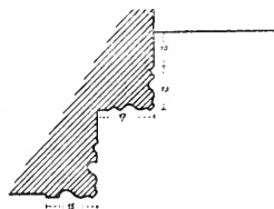
Obr. 24. Hořešovice Velké. Kamenné ostění bývalého vchodu.
