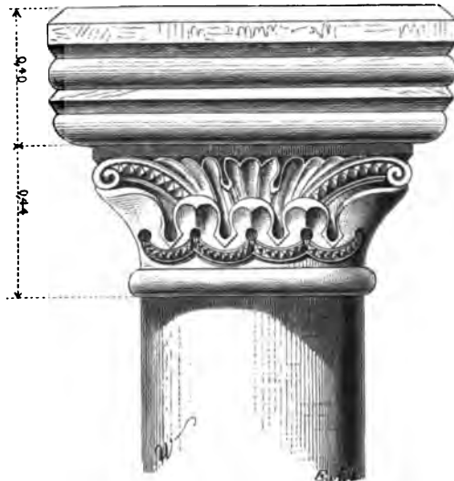
Fig. 89. Kapitell der Bündelpfeiler an der Vierung, nach Kraus.
