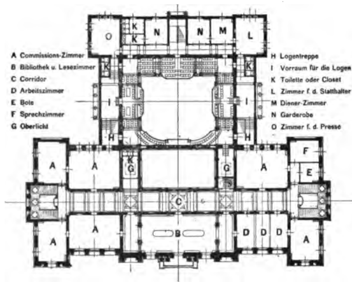
Fig. 320. Landesausschussgebäude. Grundriss vom Obergeschoss.
