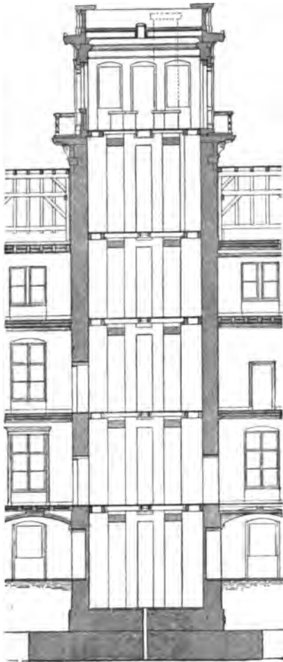
Fig. 374. Physikalisches Institut. Schnitt durch den Thurm.
