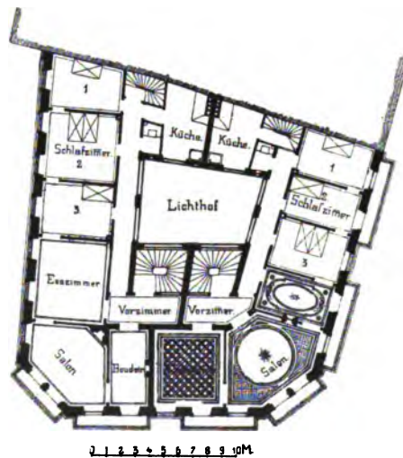
Fig. 489. Versicherungsgesellschaft Rhein & Mosel, Grundriss der oberen Geschosse.
