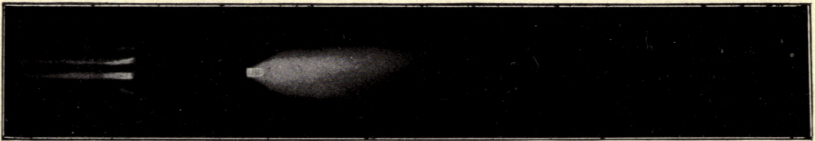
(d) EXCESS-OXYGEN FLAME (SHORT CONE).
