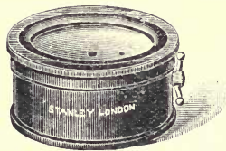
Fig. 295.— Ionide's artificial horizon.
