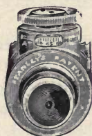
Fig. 242.— Stanley's patent subtense diaphragm.
