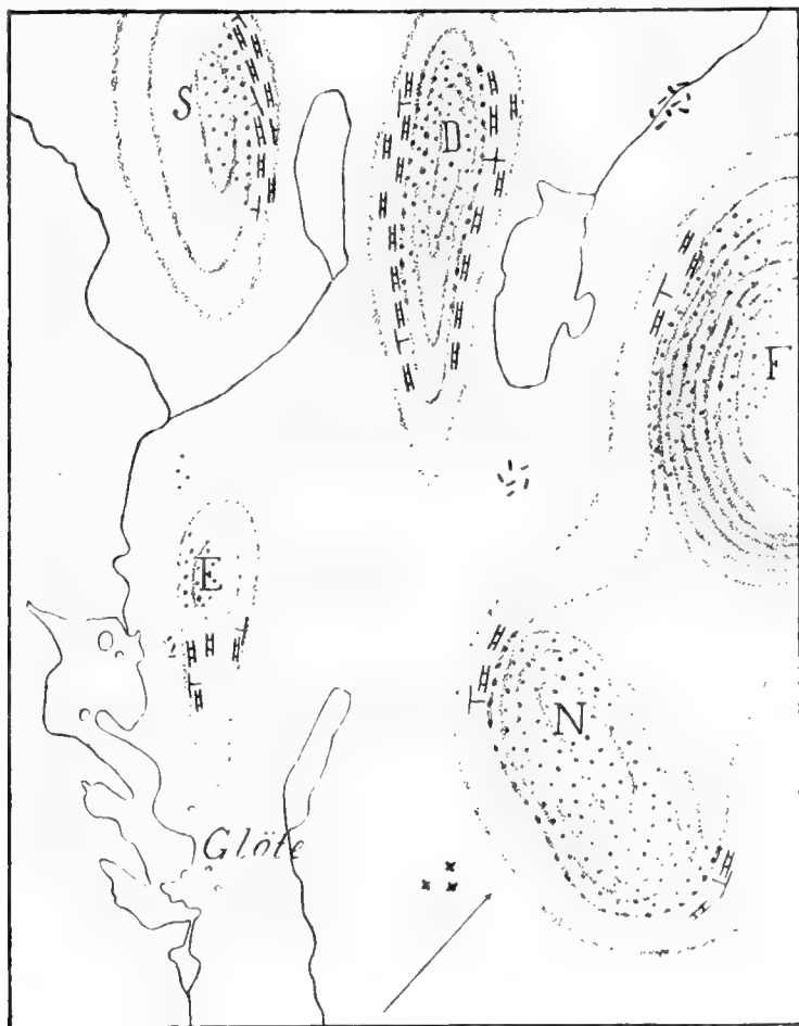
S Svartåsen; D Dykersberget; F Finnsvedåsen; N Noliåsen; E Glöt-Eggen. Prickning utmärker Vemdalskvartsit ; stegformade tecken Ortocerkalk ; korta och tjocka streck porfyr ; kors. diabas . Höjdmärkingen är endast ungefärlig.
