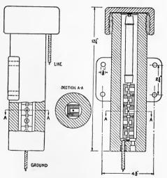
Fig. 134.—Schweitzer & Conrad multi-chamber arrester.
